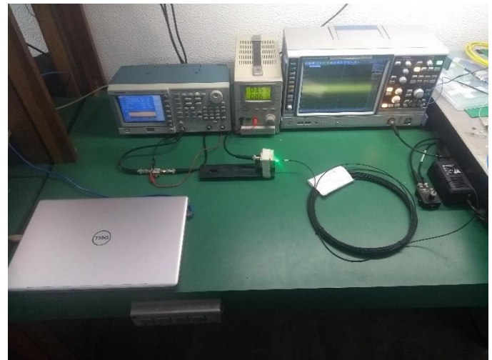
Figura 1 (a) Setup Experimental com LED centrado em 560 nm.
