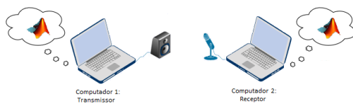
Figura 1. Esquema físico da estrutura do modem acústico.
